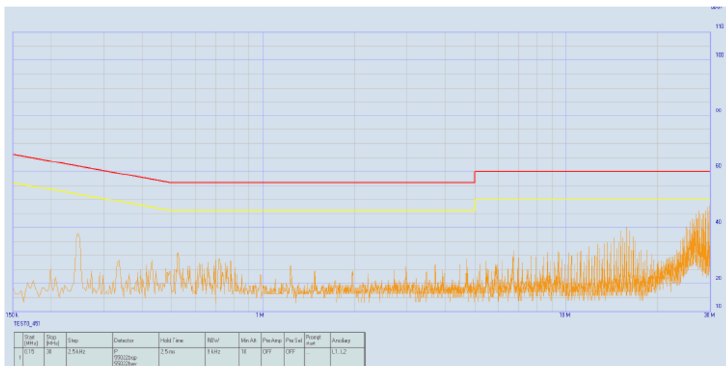
电源模块基础切换带宽 260 kHz.
